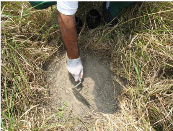
3. preparazione del punto di prelievo tramite pulizia dell'area nell'intorno del punto prescelto con falchetto e vagliatura manuale per privare il campione della frazione granulometrica superiore a 2 cm;
