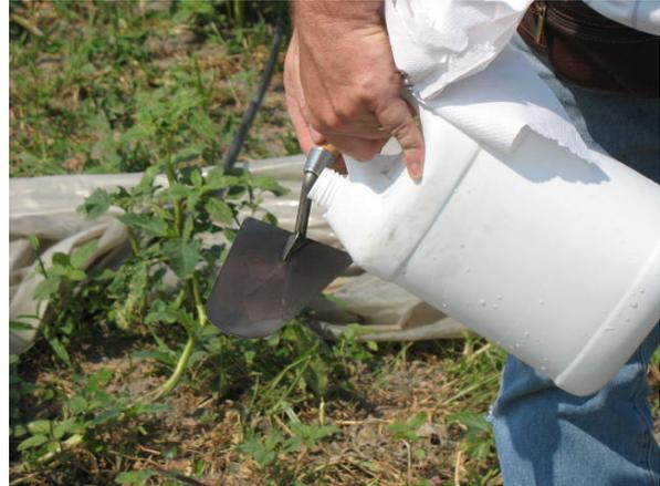
2. decontaminazione dell'attrezzatura utilizzata per il campionamento mediante lavaggio con acqua distillata ed asciugatura;
