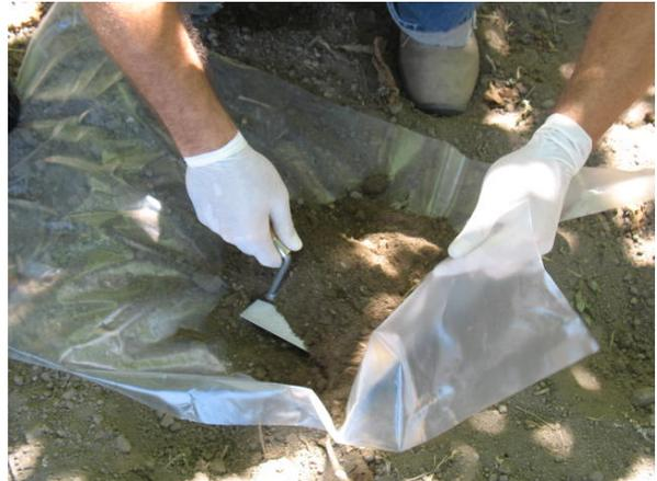
4. preparazione del campione consistente sia nella vagliatura manuale, atta a privare il campione della frazione granulometrica superiore a 2 cm sia nel miscelamento, su telo in polietilene rinnovato ad ogni prelievo;
