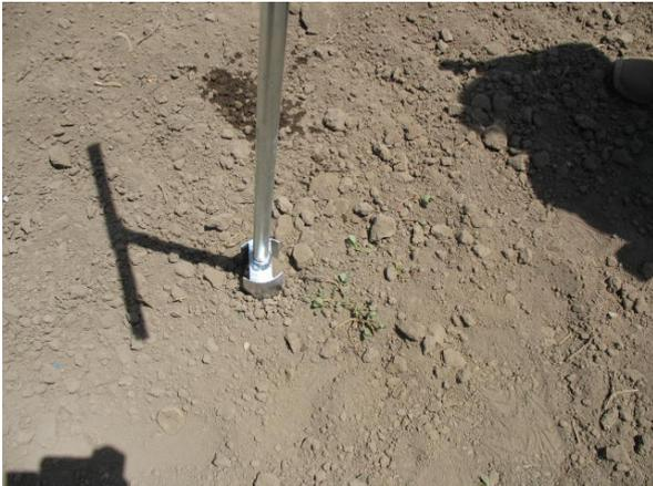
3. campionatura mediante carotiere manuale ad infissione;
