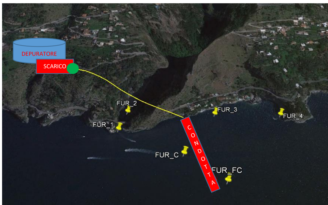
Figura 111. Schema di campionamento adottato a Furore. Il punto in verde rappresenta il prelievo di acque reflue allo scarico del depuratore. I punti in giallo rappresentano i punti di prelievo a mare. La linea gialla è il collegamento "ideale" tra lo scarico del depuratore e la condotta sottomarina
