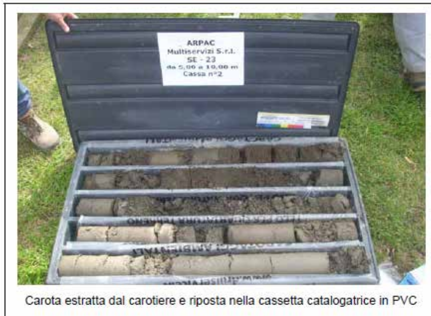
Figura 120. Carota estratta dal carotiere e riposta nella cassetta catalogatrice in PVC
